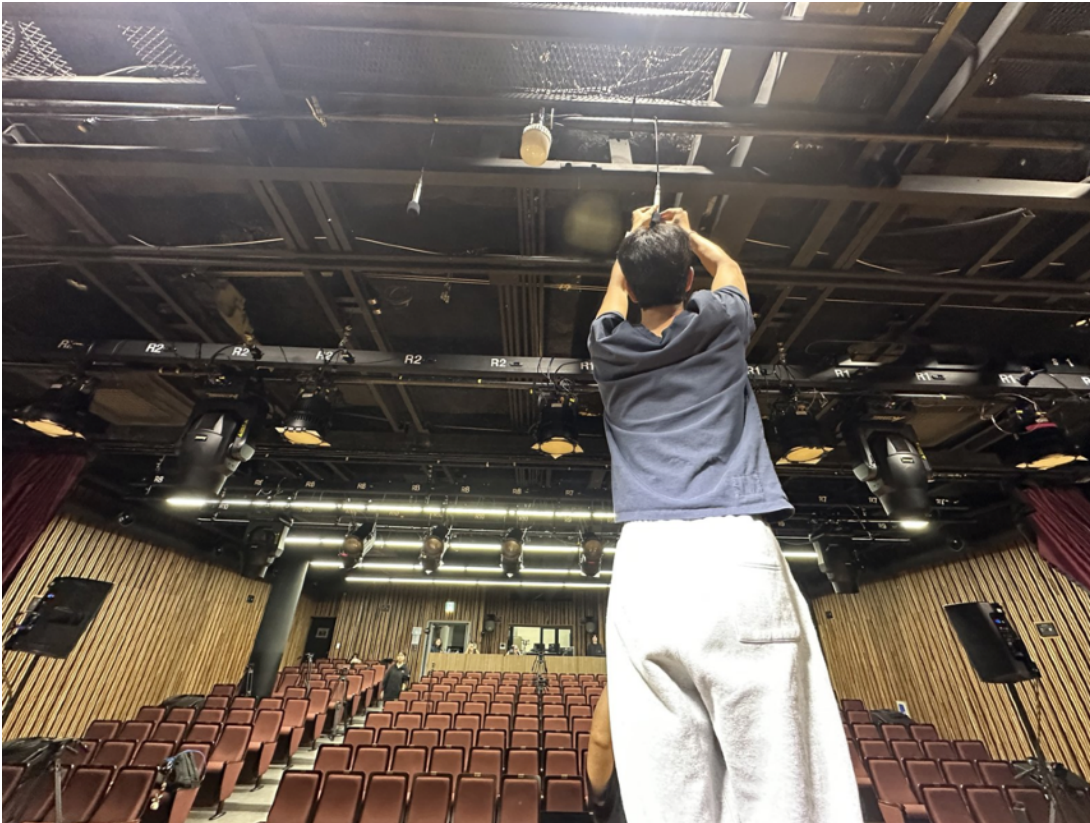
그림 5. 무대 상부에 AB 방식으로 리강한 RØDE NT5 마이크 페어. 이 마이크가 시스템의 인풋 신호가 된다.
