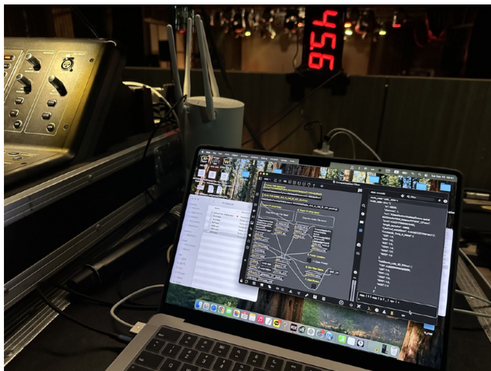
그림 9. 현장에서 보정 IR을 생성하고 있는 모습.
